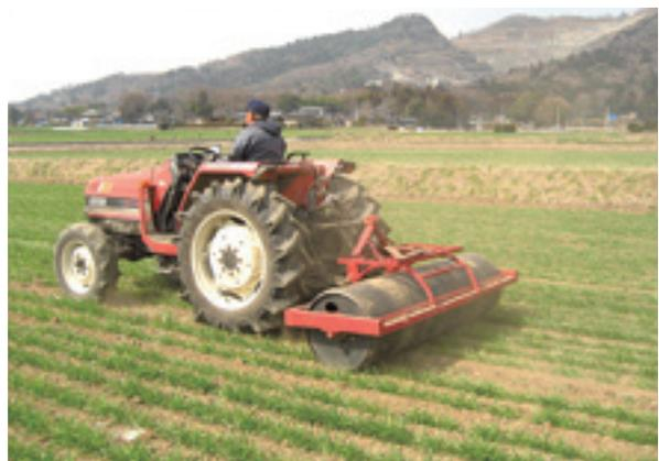
写真2 トラクタに平滑ローラを装着しての麦踏み
