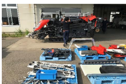
コンバイン分解清掃 (異品種混入防止対策)
