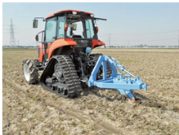
写真1 排水対策（カットドレーン）
