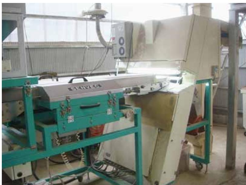
図 3 従来のカラーセンサーに加えて近赤外センサーによる分別機能も有する色彩選別機
