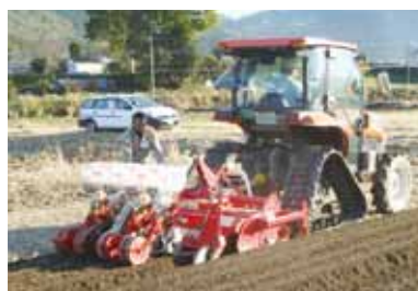
写真2 耕うん同時畝立て播種技術 爪の改良を施した逆転ロータリ(上図) 作業の様子(下図)
