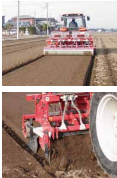
写真 3 作溝同時播種作業(上図)、ロータリ側方のアタッチメント(下図)
