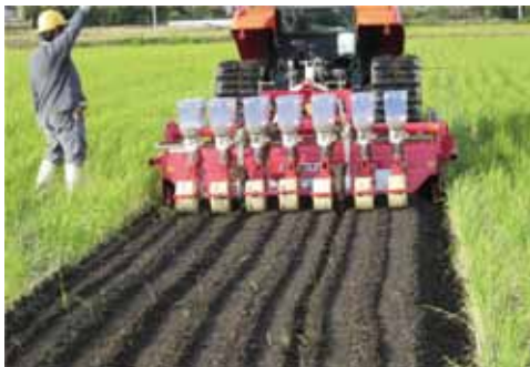
写真 3 耕うん同時畝立て播種作業
